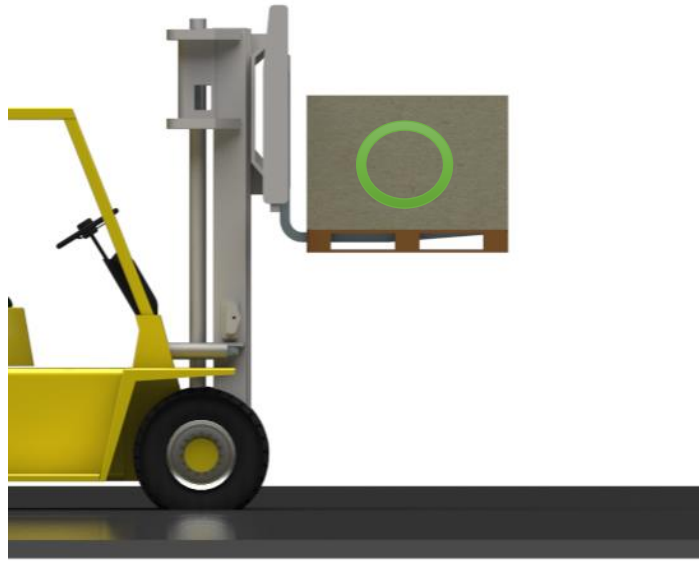
Figura 9 - forma correta de carregar uma unidade de carga que será alocada em uma estrutura porta pallets
