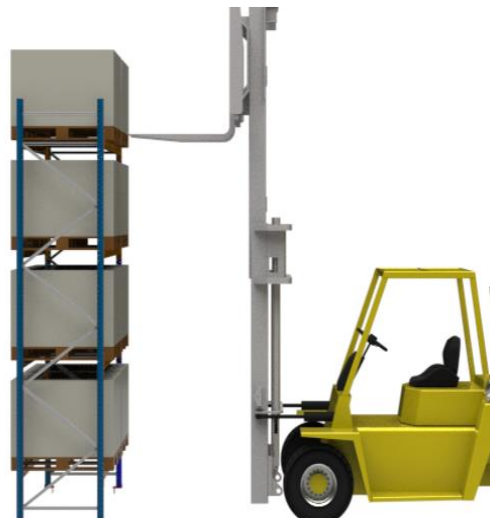
Figura 10 - Sequência de carregamento do pallet no Porta Pallets
