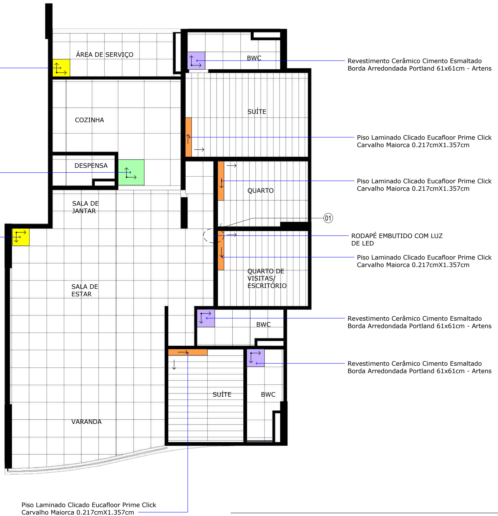
1 Planta de paginação de piso ESCALA: 1 : 75
