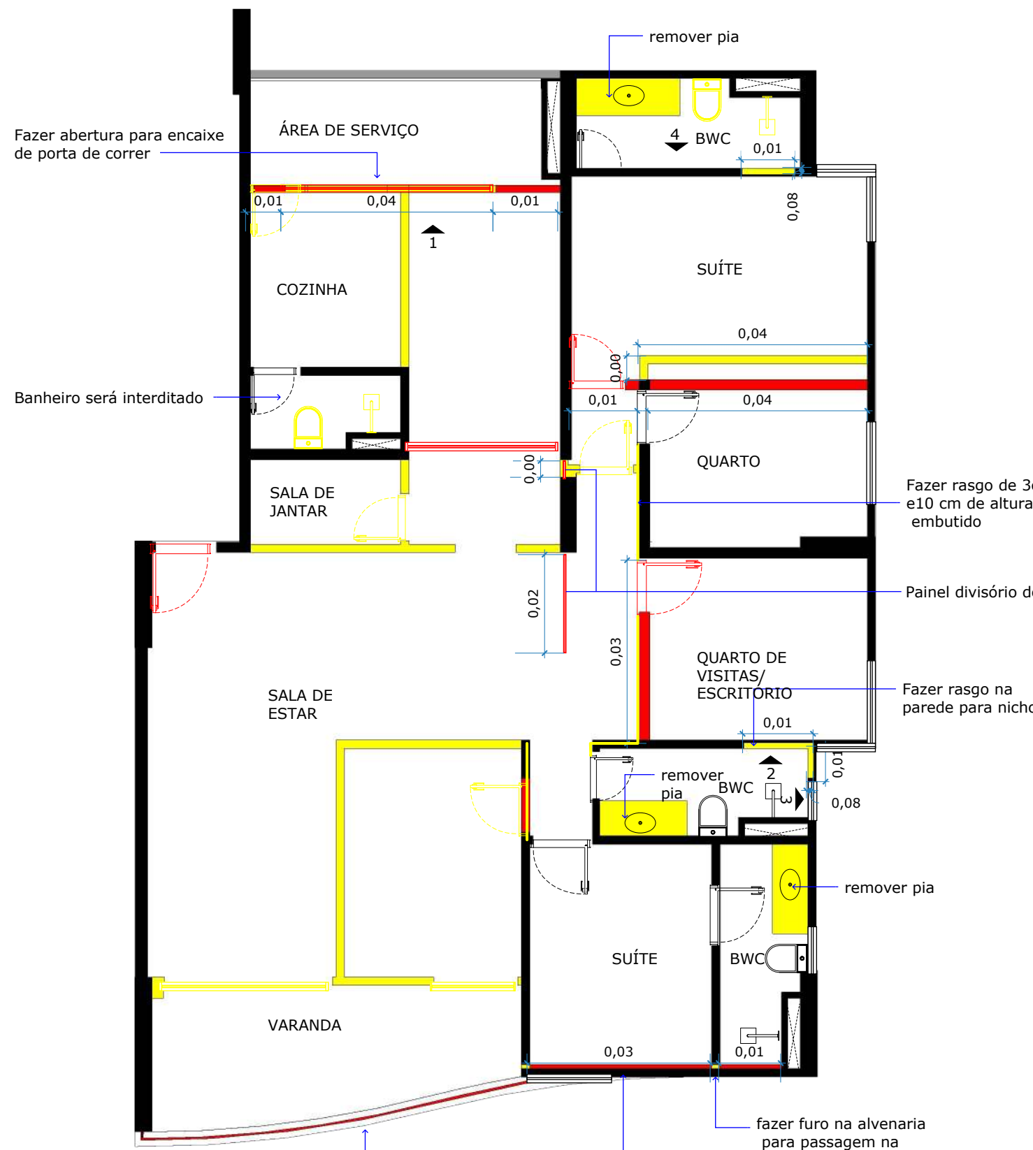
1 Planta de demolição ESCALA: 1 : 75
